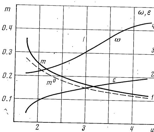
Изложенное выше подтверждает целесообразность использования линейной характеристики амортизатора при достаточно больших значениях  $u$  (по крайней мере, при  $1.9 \leq u \leq 4.3$ ). Наоборот, при значениях  $u$ , близких к единице, расхождение между  $m$  и  $m^*$  значительно, и поэтому для защиты объекта при малых уровнях допустимого абсолютного ускорения ( $1 < u < 1.9$ ) использование линейной характеристики становится неподходящим.
